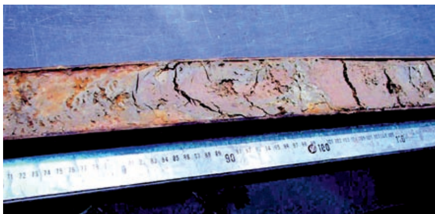
Образцы керна с глубины 2100 метров новоэвксинских отложений, прослой аналогов шоколадных глин возрастом 15 тыс. лет.
